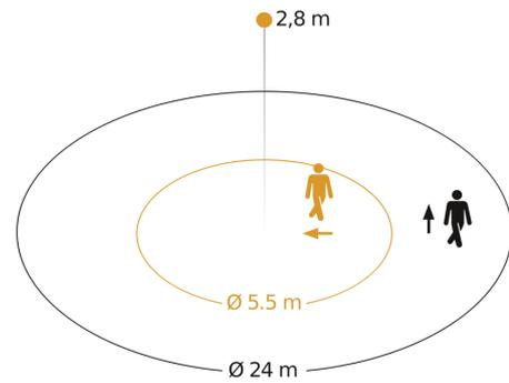
Possibile altezza di montaggio: 2,00 m - 4,00 m
